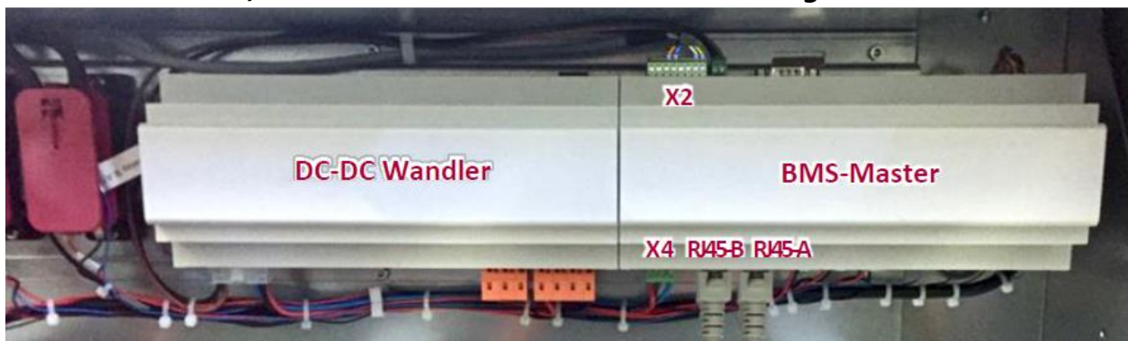
Abbildung 9: Anordnung BMS-Master, DC-DC Wandler, Relais und Vorladewiderstand
