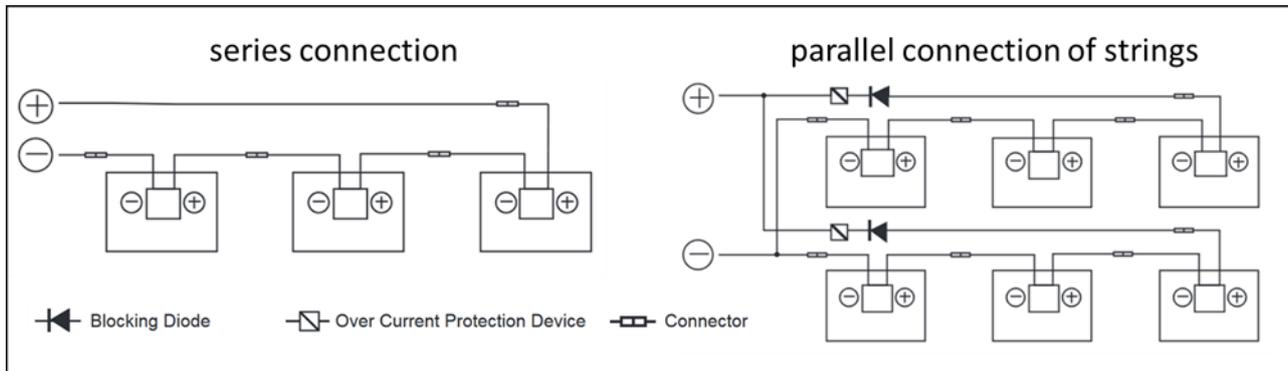
Pour le branchement des modules en parallèle, des mesures adaptées pour une protection contre les surintensités (par ex. fusible du câble) sont nécessaires. Il faut veiller à ce que la capacité de charge indiquée pour le courant de retour selon la fiche technique ne soit pas dépassée. S'il y a plus de deux chaînes parallèles, des fusibles string et des diodes string doivent être utilisés
