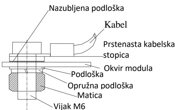
Uzemljenje modula treba izvesti u skladu s državnim zahtjevima i propisima. Ako na zgradi već postoji sustav gromobrana ili je predviđen, fotonaponski sustav mora se ugraditi u koncept zaštite od izravnog udara groma. Pri uporabi izmjenjivača bez transformatora, može biti propisano izjednačenje potencijala sukladno podacima proizvođača izmjenjivača. Moraju se pridržavati državni zakoni.
