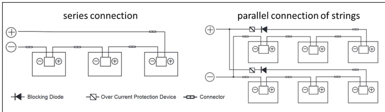
Za paralelno spajanje modula potrebne su prikladne mjere zaštite od previsoke struje (npr. linijski osigurač). Treba paziti na to da se ne prekorači navedena opteretivost povratnog toka sukladno Tehničkom listu. Ako postoje više od dvije paralelne žice, moraju se koristiti osigurači i diodne žice.
